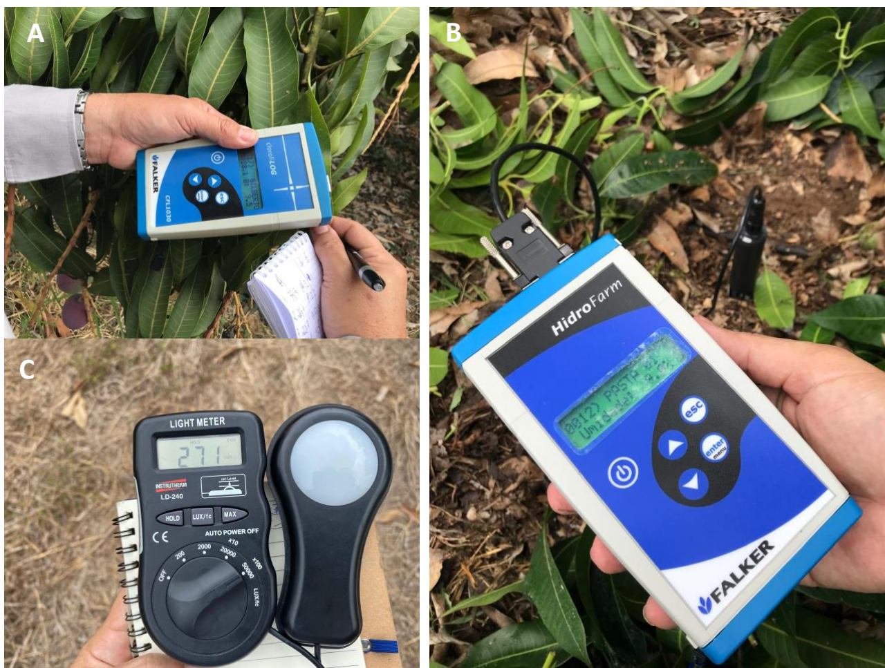
Figura 1: Mediciones de los índices de clorofila foliar (A), humedad del suelo (B) e intensidad de la luz solar (C) en los huertos experimentales durante la fase de caracterización.
