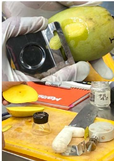
**Figura 3.** Determinación de la firmeza (kgf) del mango Ataulfo por medio de la resistencia a la punción.
