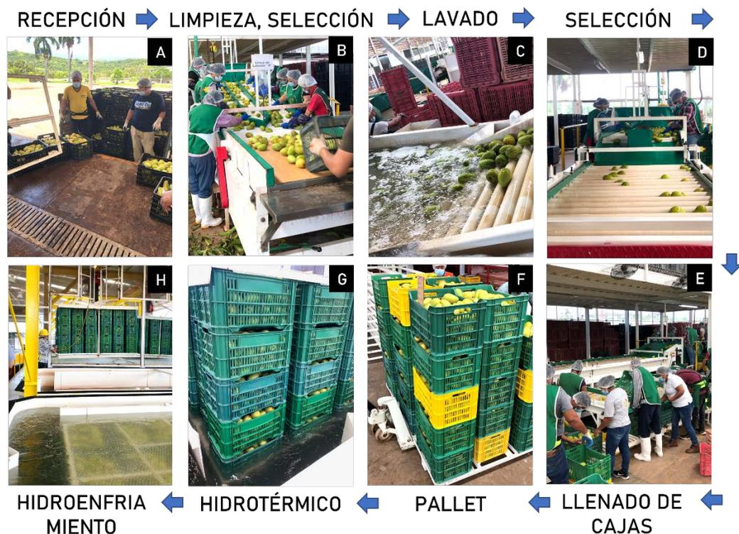
**Figura 1.** Diferentes etapas por las que transita el mango Ataulfo dentro de la empacadora.
