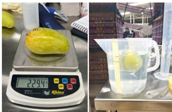
**Figura 2.** Determinación de la densidad (g/ mL) del mango Ataulfo por medio del registro del peso y el volumen de agua desplazada por el mismo fruto.
