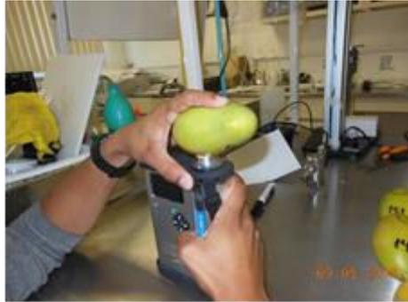
**Figura 11.** Determinación de madurez en mango ‘Ataulfo’ mediante espectrometría.
