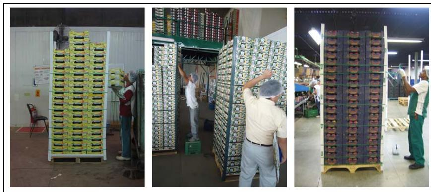
**Figura 6: Paletización y uso de bandas de plástico para asegurar las paletas cargadas**
