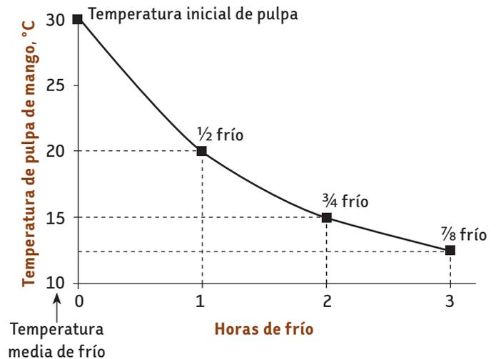
La curva de enfriamiento para el sistema de pre-enfriamiento con tiempo de frío de 1 hora. Los frutos son enfriados desde una temperatura inicial de la pulpa de fruto de 30°C a 12.5°C (7/8-frío) en 3 horas usando aire a una temperatura de 10°C como la temperatura media de enfriamiento o frío (basado en una diferencia de 20°C entre la temperatura inicial de la fruta de 30°C y la temperatura media de enfriamiento de 10°C)
