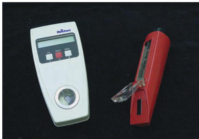
Refractómetros manuales medidores digitales de escala (derecha) y de escala visual (izquierda)
