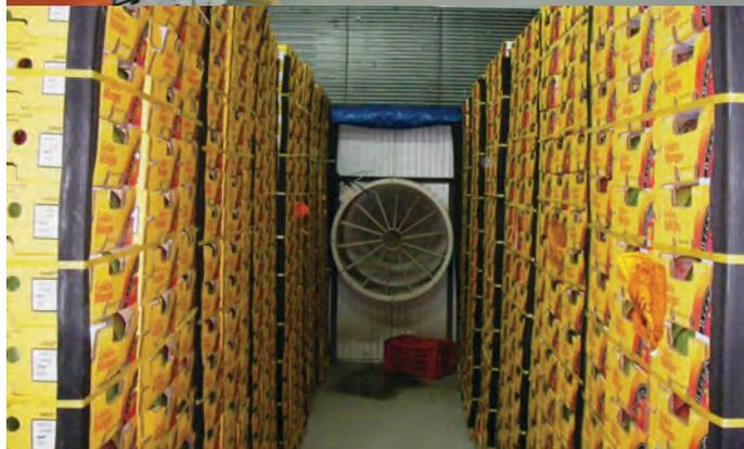
Conductos y túneles de enfriamiento con aire forzado
