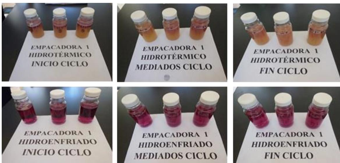
**Figura 11. Ilustración del resultado de los muestreos para Presencia/Ausencia de *Coliformes totales* del agua de proceso en empacadoras de mango para exportación. Amarillo (+) Púrpura (-).**
