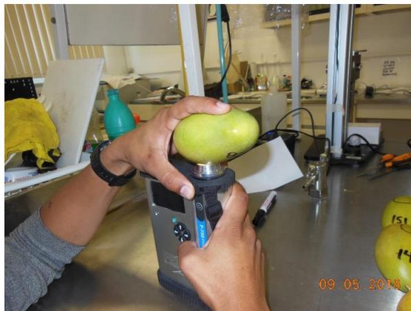
**Figura 2. Determinación de madurez en mango ‘Ataulfo’ mediante espectrometría.**
