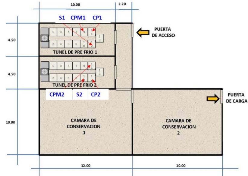
Capacidad de pallets por tunel: 13 pallets
