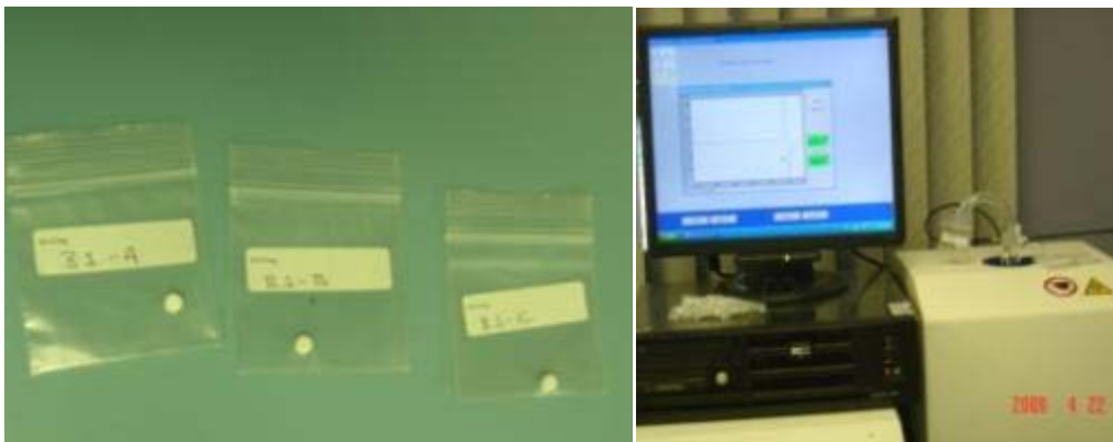
Dosímetros de alanina y equipo de Resonancia de Espín Electrónico utilizado para el registro de dosis absorbida
