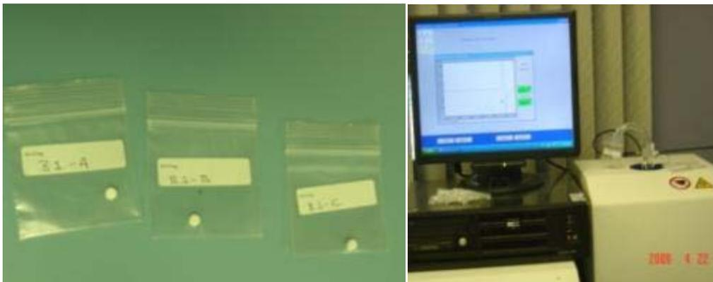
Dosímetros de alanina y equipo de Resonancia de Espín Electrónico utilizado para el registro de dosis absorbida
