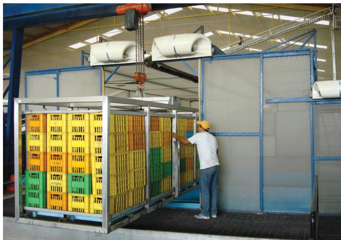
Resfriamento com água após tratamento com água quente
