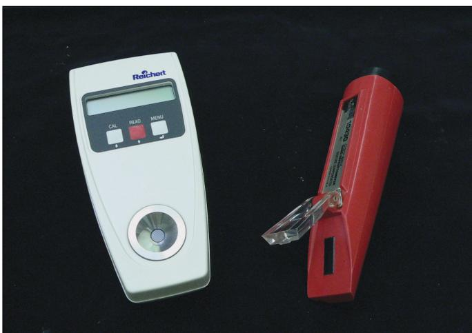
Refratômetros portáteis com escala digital (esquerda) e escala visual (direita)
