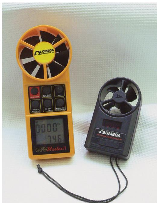
Anemômetros com ventoinha usados para medir a velocidade do ar
