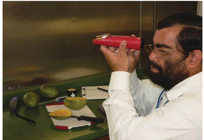
Medindo o SST da manga com um refratômetro
