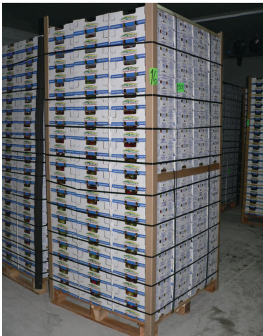
Visão diagonal de um palete de quatro entradas, caixas alinhadas e dentro dos limites do palete, cantoneiras, e fitas de amarração, e pallet board (papelão com o mesmo padrão de perfuração e encaixe das caixas) inserido entre camadas de caixas para manter a orientação para o empilhamento correto.
